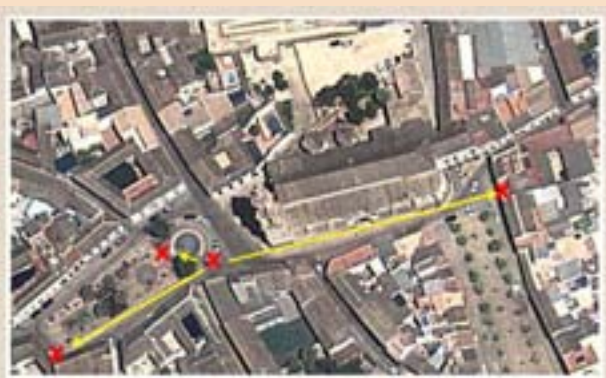
Ubicación de las Bases de Replanteo
